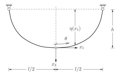
Ermittlung der Belastung  $q_3\left(x_1\right)$  für homogene Seile:
