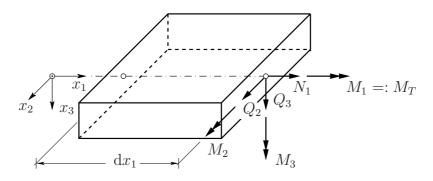
**Merke:** Positive Schnittgrößen weisen am positiven Schnittufer in positive Koordinatenrichtung.
