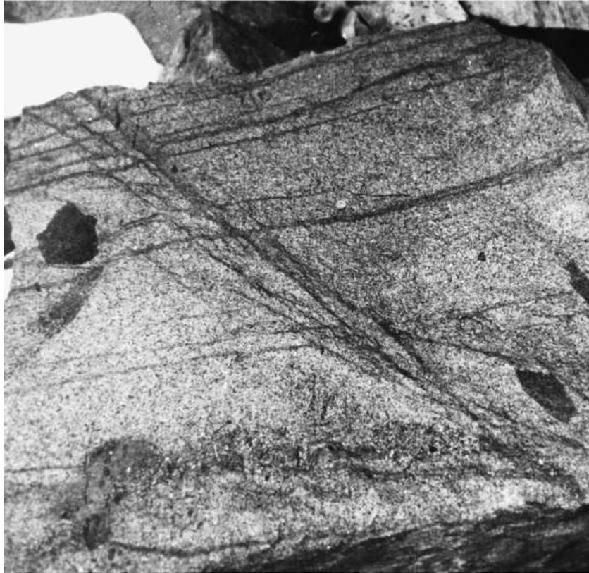
**Bild 1.1:** Scherbänder in einem Granitblock
